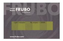
Die Farben eines Drucks sind stark von der verwendeten Lichtquelle abhängig. Deshalb ist es wichtig, dass sie immer unter einem Normlicht von D50 (5000 K) beurteilt werden. Verwendet man eine Lichtquelle mit falscher Farbtemperatur, verschieben sich die Farben des Drucks und eine Beurteilung macht keinen Sinn. Mit dem
